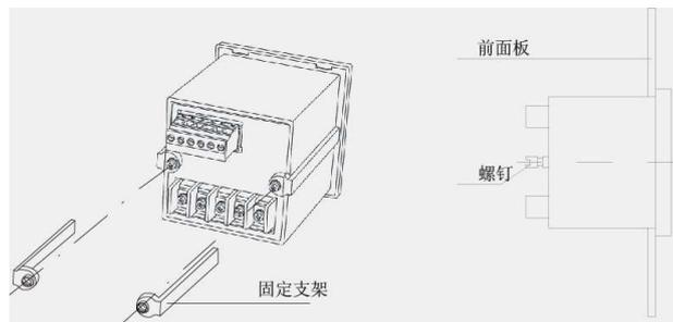
图 2 PZ 系列直流表安装示意图
