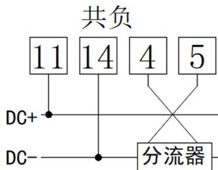
图 4 外置分流器接线示意图
